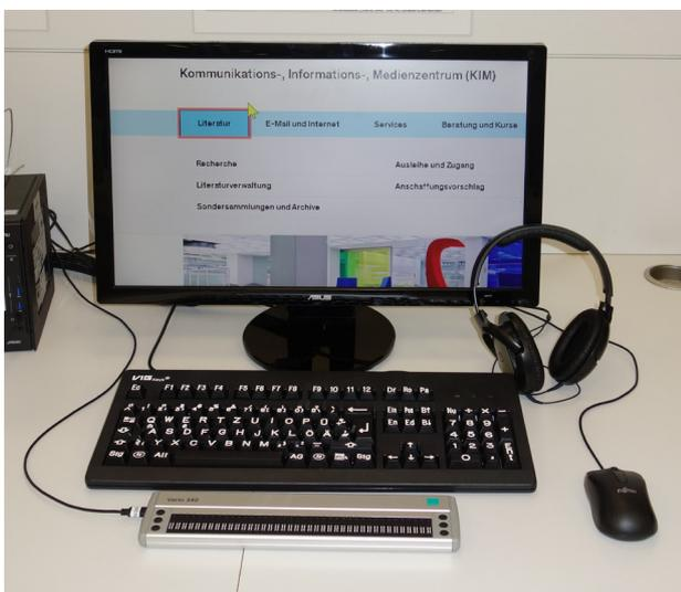
Der PC ist mit der Software „COBRA 11“ für Vergrößerung, Sprachausgabe und Brailleausgabe ausgestattet.
