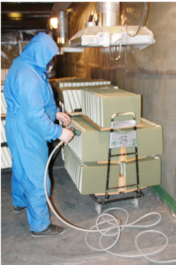
Bild 3: Mit Druckluft werden die Bände vom Staub gereinigt, die Asbestfasern werden angesaugt und gefiltert.
