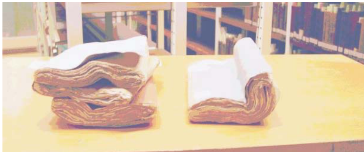
Abb. 2: Beispiele für schwerwiegende Verformungen und Wellungen von gefriergetrockneten Büchern
